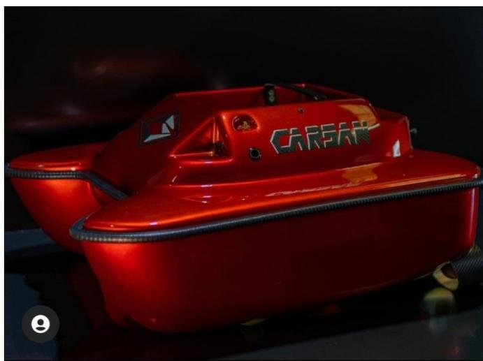
Los barcos llevan un sonar manipulado mediante radiocontrol que permite tener un mapa batimétrico (muestra el relieve del fondo en planos dimensionales permitiendo detectar cualquier elemento). Que el manejo de estos elementos se realice a través de control remoto es un invento llevado a cabo por él.
